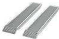
505 69 90-40 Lastramper Lastramper av havsvattentålig aluminium med den välkända halkskyddsytan O3, som ger alla slags hjul ett gott grepp även i våta och hala miljöer. Lastramperna passar väl för användning på släpkärror med en maximal höjd om 700 mm och för en total belastning om 450 kg per par. Ramperna säljs i par. Dimensioner: 200x1500x35 mm.
