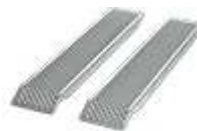
505 69 90-42 Lastramper Lastramper av havsvattentålig aluminium med den välkända halkskyddsytan O3, som ger alla slags hjul ett gott grepp även i våta och hala miljöer. Lastramperna passar väl för användning på släpkärror med en maximal höjd om 700 mm och för en total belastning om 450 kg per par. Ramperna säljs i par. Dimensioner: 200x2000x50 mm.
